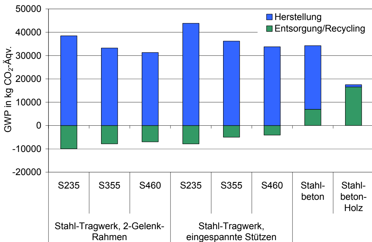
Abbildung 6: Treibhauspotenzial für Herstellung und Entsorgung der verschiedenen Tragwerke mit zugehörigen Fundamenten, Darstellungsvariante b
