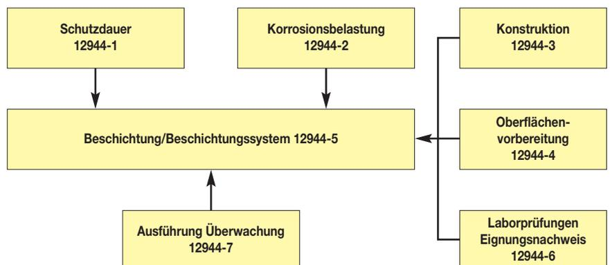
Abbildung 1: Spezifikation von Beschichtungssystemen in Anlehnung an DIN EN ISO 12944-8
