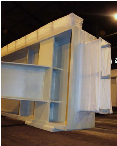
Bild 6: Detailausführung eines an eine T-Rippe angeschweißten I-Querträgers; links: Praxisbeispiel Fertigung; rechts: verzinkungsgerechte Ausführung mit Durchflussöffnungen
