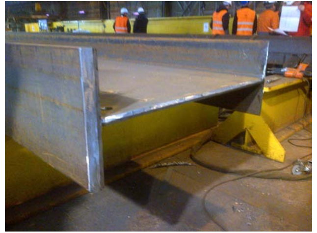
Bild 21: Schweißnahtvorbereitung für einen geschweißten Stumpfstoß von warmgewalzten Breitflanschträgern für eine Verbundbrücke
