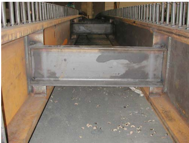
Bild 17: Detailausführung geschweißter U-Querträgeranschluss an Aussteifungsblechen inklusive Stegverstärkung des Hauptträgers; links: Praxisbeispiel Fertigung; rechts: verzinkungsgerechte Ausführung mit Durchflussöffnungen
