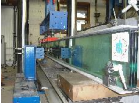
Geklebter Stahl-Glas Träger mit Länge 10m (Forschung) © Prof. Bucak
