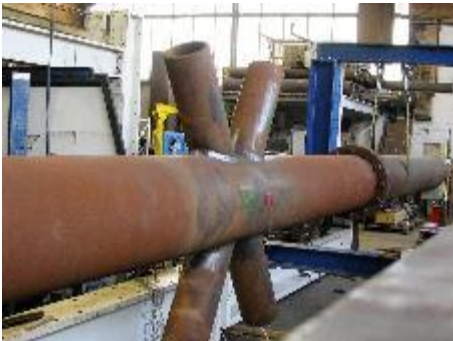
Ermüdungs-Bauteilversuch geschweißter Doppel K-Knoten mit Länge 10m (Forschung) © Prof. Bucak
