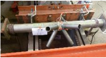
Ermüdungsversuch an geschweißtem K-Knoten (Forschung) © Prof. Bucak
