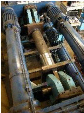
Belastungsversuche geklebter Stahl-Stahlguss Knoten (Forschung) © Prof. Bucak
